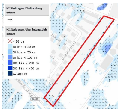
Abbildung 5: Darstellung Überflutungstiefen und Fließrichtungen (ohne Maßstab) – www.geoportal.de
